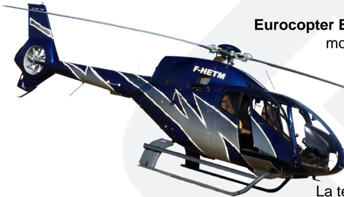
**Eurocopter EC 120 B : Le Colibri** est un hélicoptère léger monoturbine conçu par Eurocopter, et assemblé dans ses ateliers à Marignane. Il a été conçu pour transporter un pilote et quatre passagers, et doté d'une polyvalence pour s'adapter aux besoins de ses clients, qu'ils soient des acquéreurs privés ou des organismes publics, voire militaires. La technologie à Fenestron du rotor arrière en fait l'hélicoptère le plus silencieux de sa catégorie.
